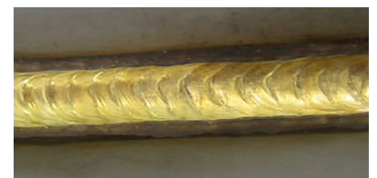
Brazing with CuAl 8 wire
